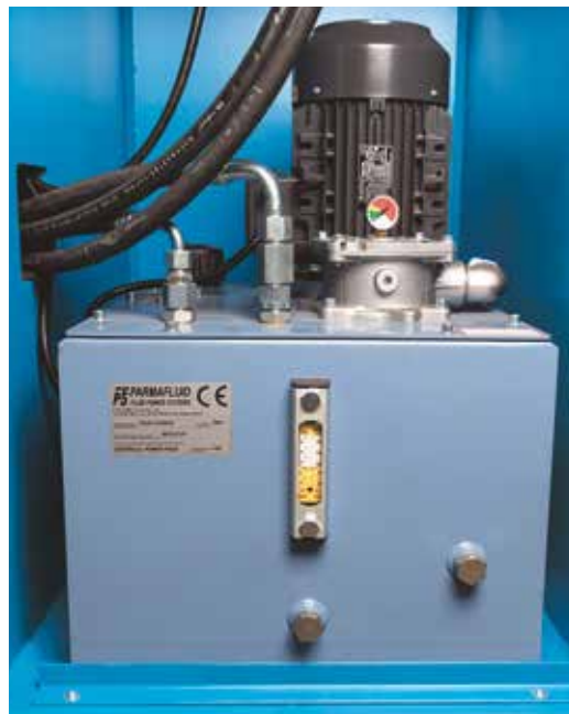
Hydraulický systém je prostorově nenáročný, avšak s dobrým přístupem zabudovaný v podstavci
