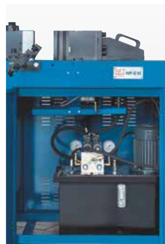
Kompaktní hydraulická jednotka umístěná v podstavci je dobře přístupná
