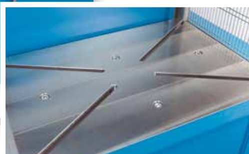
Diagonálně orientované drážky usnadňují vycentrované upnutí nástrojů
