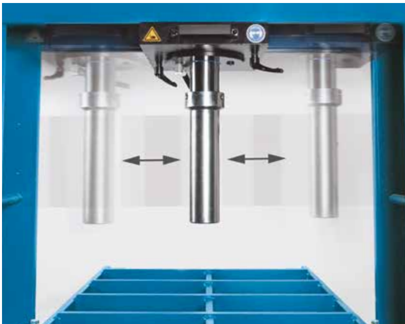
Bočně pohyblivá jednotka pracovního pístu
