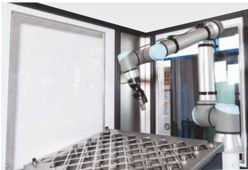
Rameno robotu se 6 osami s pracovním poloměrem 1 300 mm
