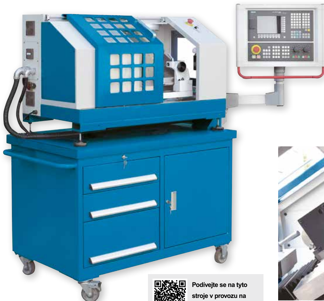
Šikmé lože pro optimalizovaný pracovní prostor a odvod třísek
