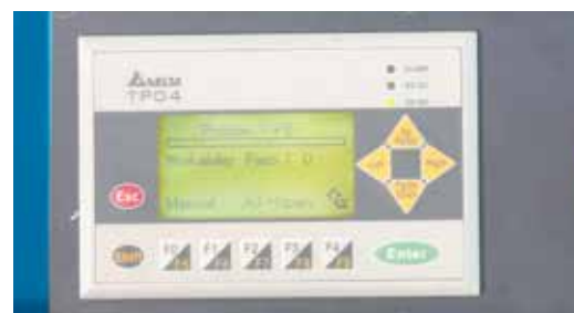
Řízení zásobníku tyčí se parametrizuje na přehledném ovládacím panelu
