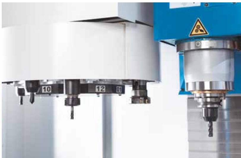
Robustní horizontální výměník nástrojů s 12 místy pro nástroje
