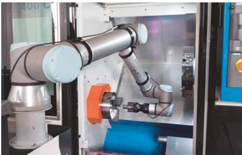
Rameno robotu se 6 osami s pracovním poloměrem 1 300 mm
