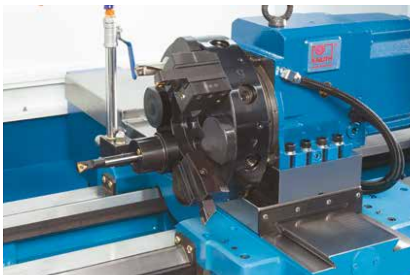
VDI 30 nástrojový revolver s 8 stanicemi
