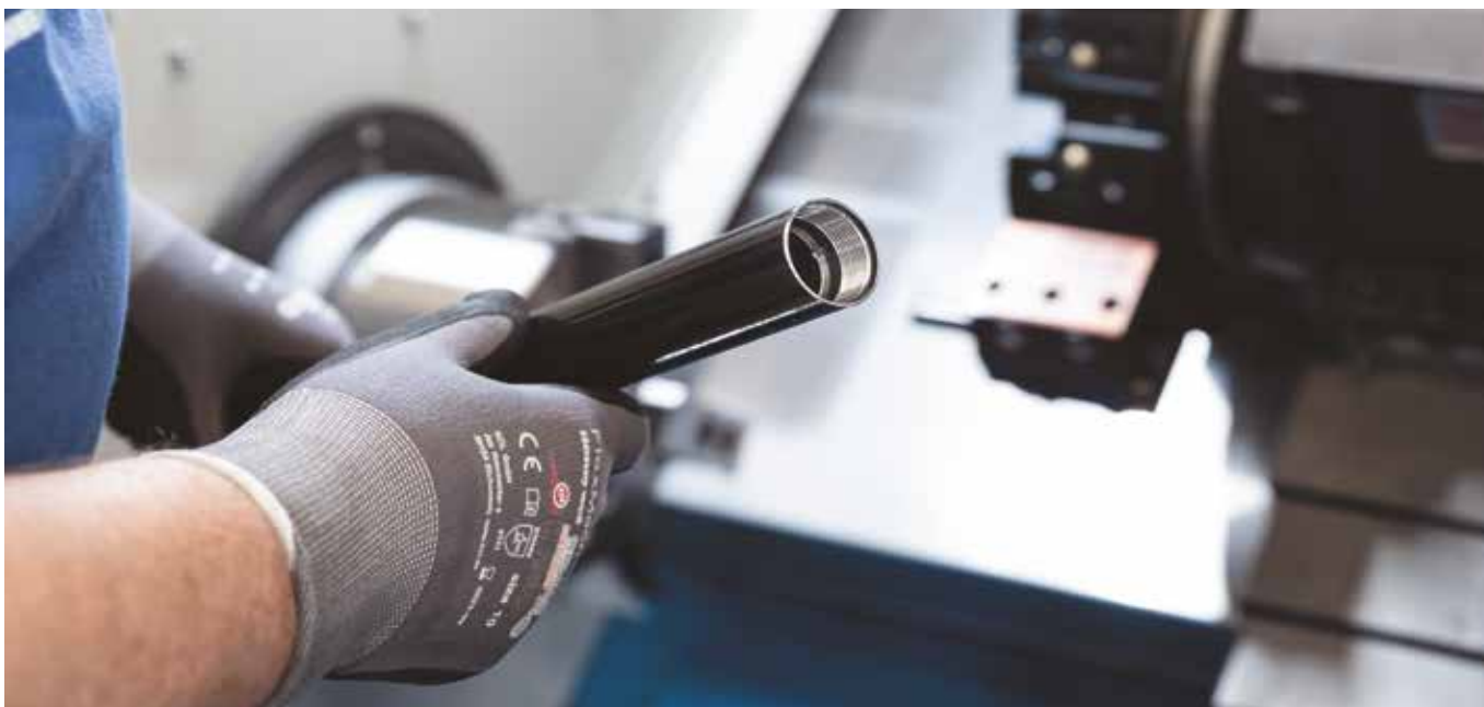
Při soustružení závitů je požadována nejvyšší přesnost. Ocelové trubky se později přesně líčují k vedení pro suchá sprchová hasicí zařízení.
