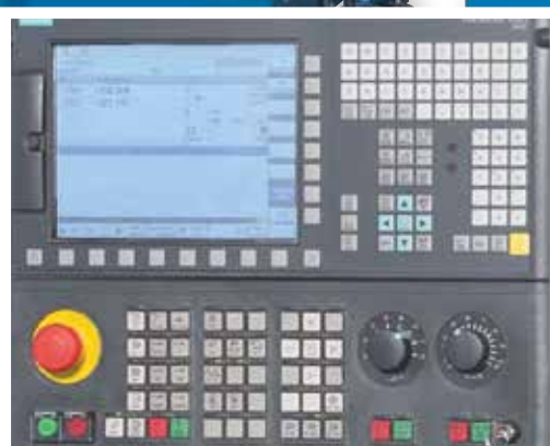
Řídicí systém Siemens Sinumerik 828 D Basic Drehen (základní obrábění) – kompaktní a uživatelsky příjemné řešení pro soustruhy
