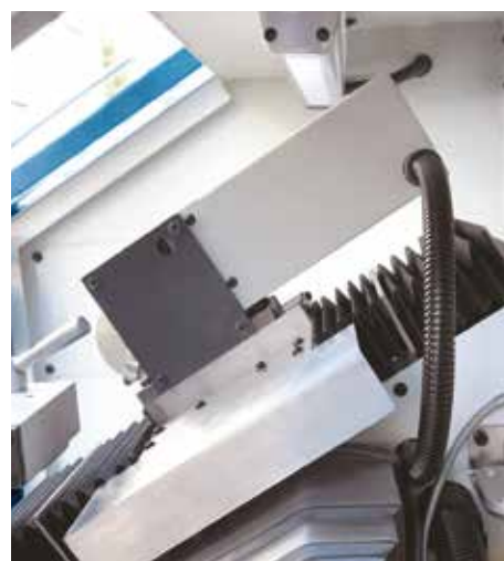
Šikmé lože pro optimalizovaný pracovní prostor a odvod třísek
