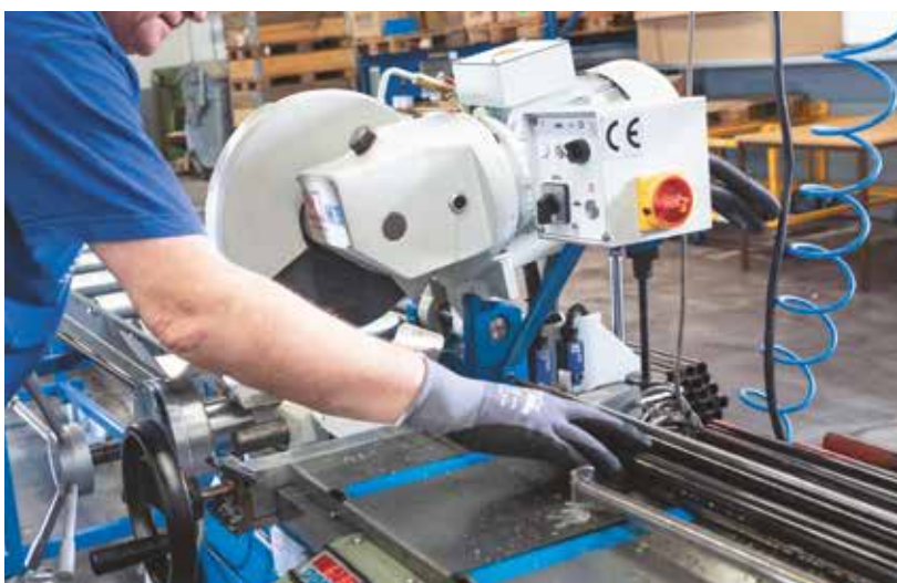
Přípravné práce provádí u firmy Minimax kotoučová pila KHK 350 s pneumatickým upínáním obrobku, také od firmy KNUTH. Řeže ocelové trubky přesně na milimetr na přesnou délku.
