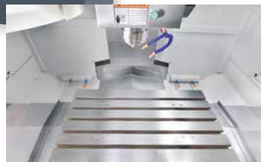
Vedení ve všech osách jsou chráněna robustními kryty z nerezové oceli
