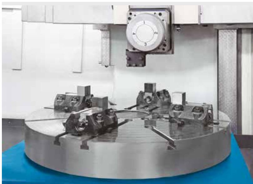
Upínací kruhová deska se 4násobným měničem nástrojů
