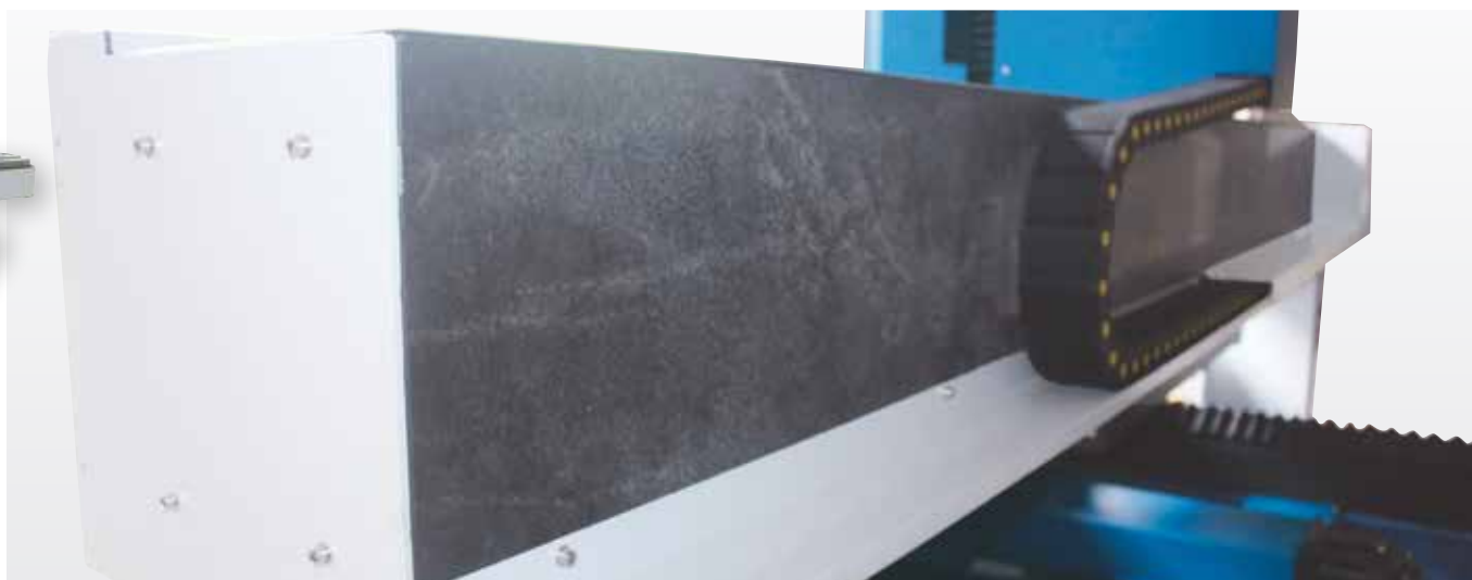
Přesně broušené granitové elementy ve všech osách
