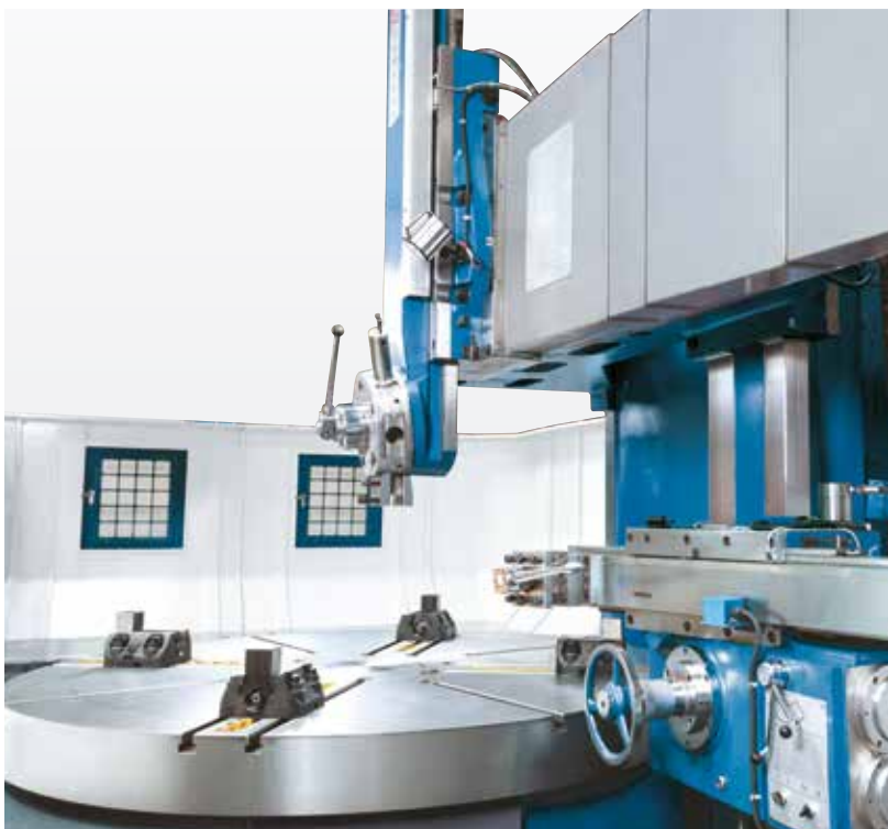
Vertikální podpora s 5násobným držákem nástroje a boční podpora s vlastním posuvem pro vnitřní a vnější obrábění
