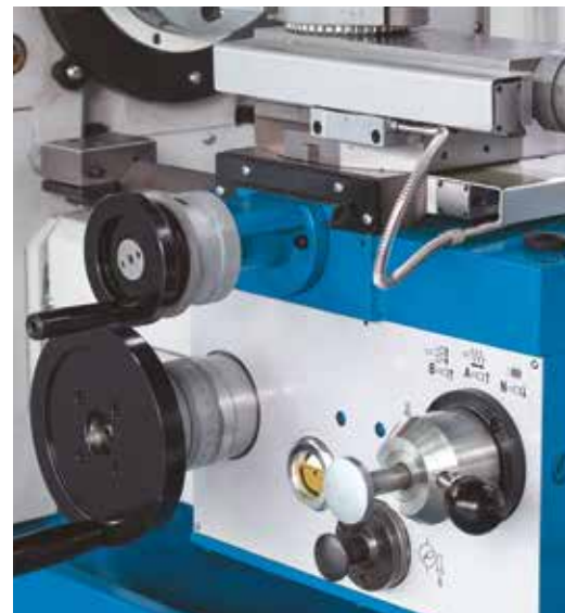
Snadnou údržbu a jednoduchou manipulaci zaručuje centrální mazání integrované v suportu
