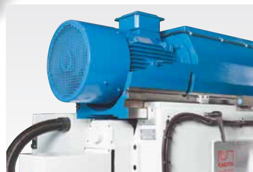
Silný hnací motor hlavního vřetene s předlohouvou převodovkou (Servomill® UWF 12)
