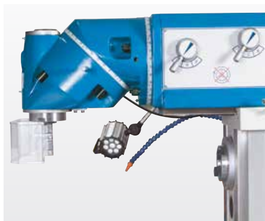
Univerzální frézovací hlava výkyvná ve 2 rovinách
