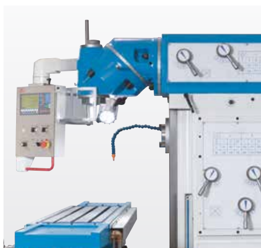
Velký pracovní prostor a frézovací hlava výkyvná ve 2 rovinách
