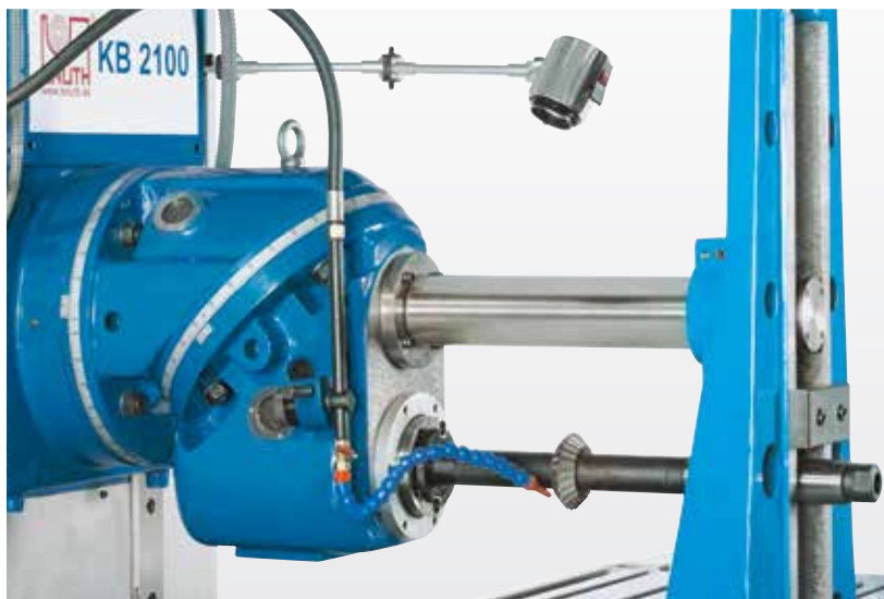
Stabilní systém podpěrného ramena pro dlouhé frézovací trny
