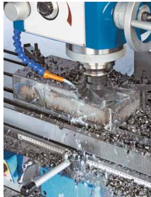
Rovinné frézování nožovou hlavou
