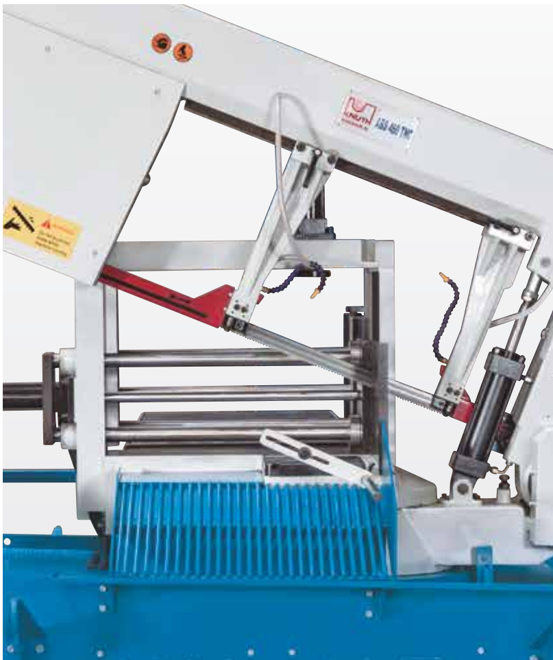
Dvojitý hydraulický portálový svěrák zaručuje maximální stabilitu i při obrábění svazků
