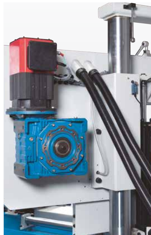
Plynule regulovatelný servomotor v vysokém točivém momentem
