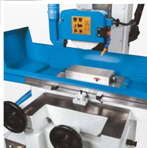
Upínací deska s permanentním magnetem s jemnou pólovou roztečí – ideální pro precizní broušení
