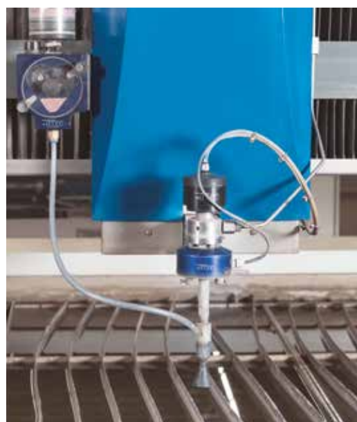
Řezací hlava a abrazivní systém jsou optimálně přizpůsobeny příslušnému vysokotlakému systému
