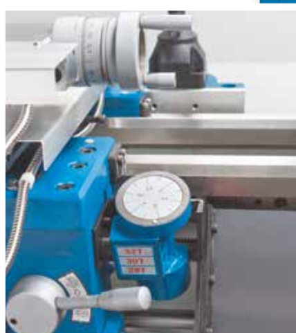
Číselníkový úchylkoměr na závity zajišťuje opětovné uchycení otočky závitu po vytočení svorkové matice pro zpětný pohyb
