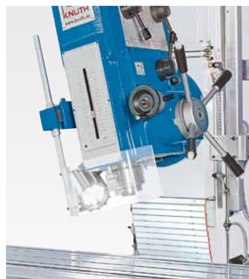
Úhlově nastavitelná vertikální hlava s automatickým posuvem pinoly
