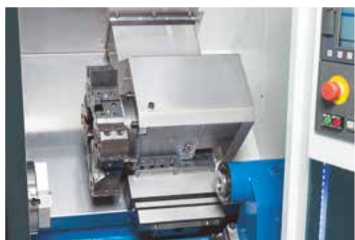
8násobný nástrojový revolver snižuje vedlejší čas
