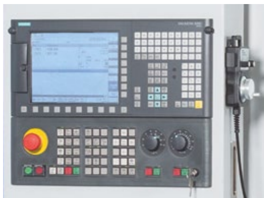
Řídicí systém Siemens Sinumerik 828 D Basic Drehen (základní obrábění) – kompaktní a uživatelsky příjemné řešení pro soustruhy
