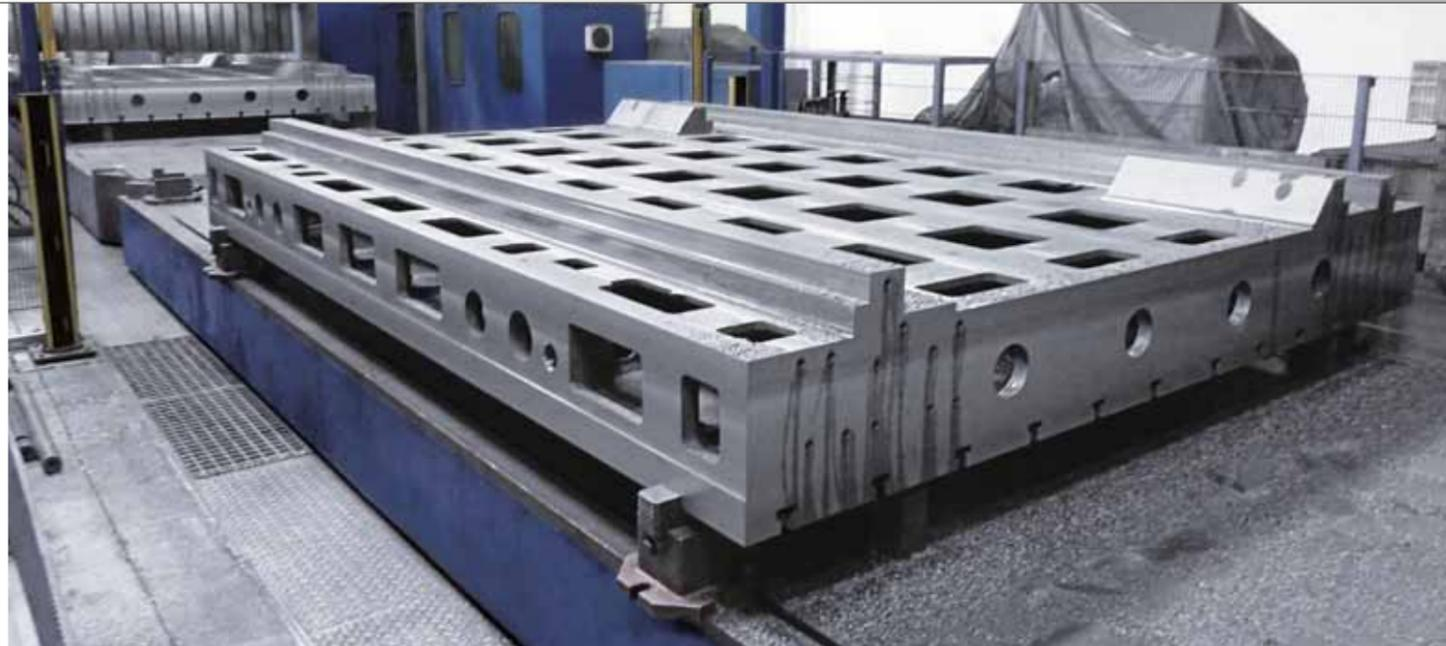
Maschinenbett zweiteilig in einer Spannung von 18.000 mm Länge bearbeitet
