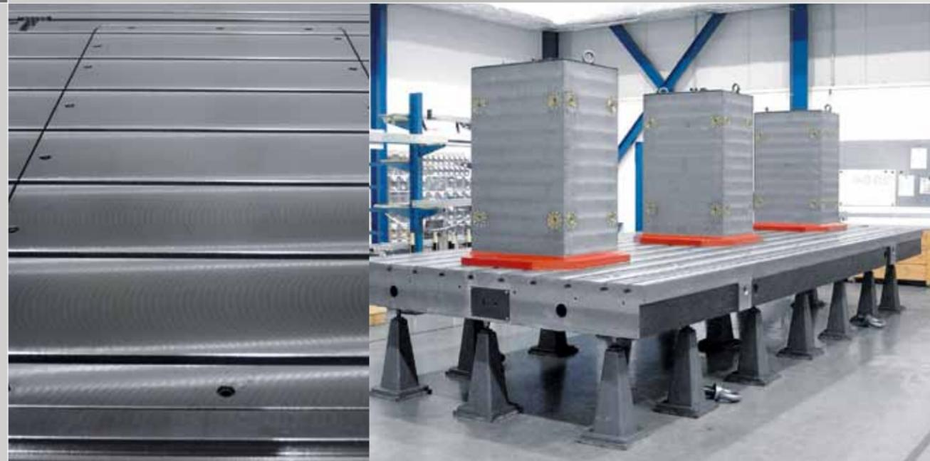
Spanntürme mit Nullpunktspannsystem
