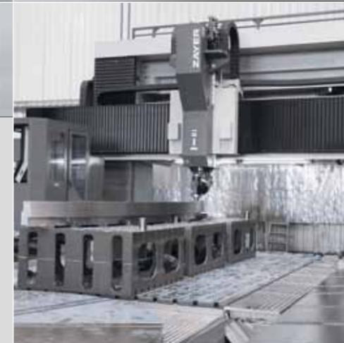
Aufspannplatte für eine Gantry Maschine
