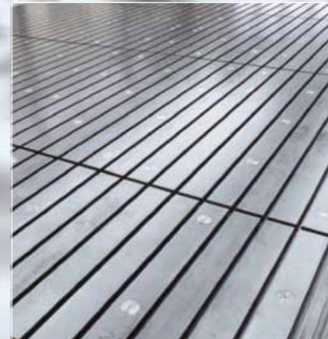
Aufspannplatte 21.000 x 11.000 mm
