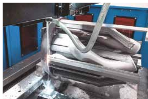
Při aditivní výrobě vznikají komplexní konstrukční díly na jedné kovové desce, která se poté musí od konstrukčního dílu oddělit (NeoSpark 500 B Continental Engineering Services)
