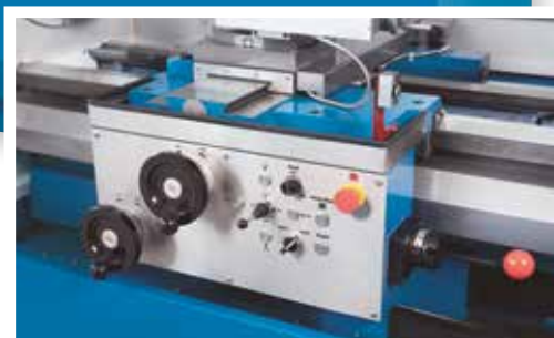
Ovládání pomocí elektronických ručních koleček v rozsahu \mu - haptika a poloha jako u konvenčního stroje
