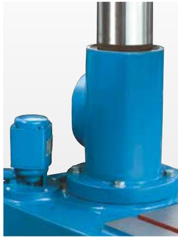
In der Maschinenbasis integrierte Kühlmittleinrichtung (KSS 25V, KSS 32)
