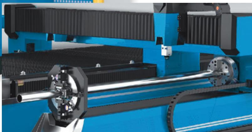
Option: Rohrschneideinrichtung bis 150 mm Durchmesser und 3 m Rohrlänge
