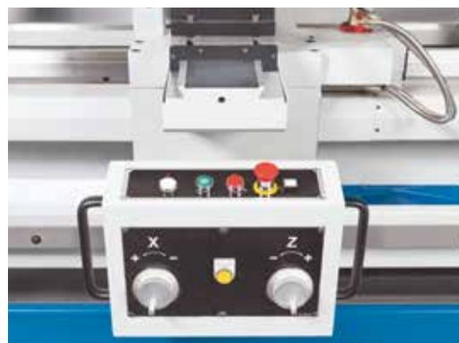
Kompakte Bedieneinheit mit elektronischen Handrädern
