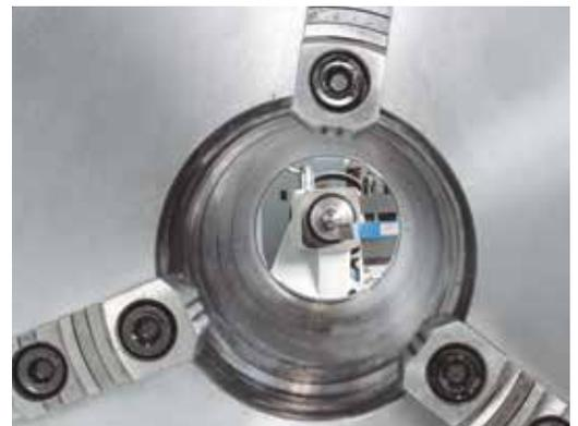
Spindelbohrung bis 225 mm
