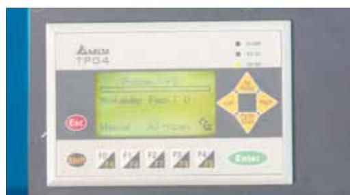
Die Steuerung des Stangenmagazins wird am übersichtlichen Bedienfeld parametrierbar
