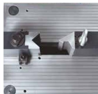
Der Biegestempel verfährt in lang abstützenden, gehärteten Führungen, die per Zentralschmierungseinheit mit Öl versorgt werden
