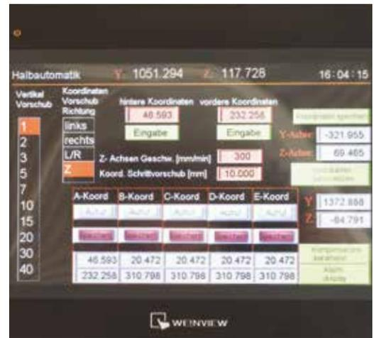
Schleifscheibenabrichtmodus mit automatischer Kompensation der Abmessung und Anpassung der Drehzahl für konstante Schleifgeschwindigkeit kann im Automatikbetrieb der Maschine eingefügt werden
