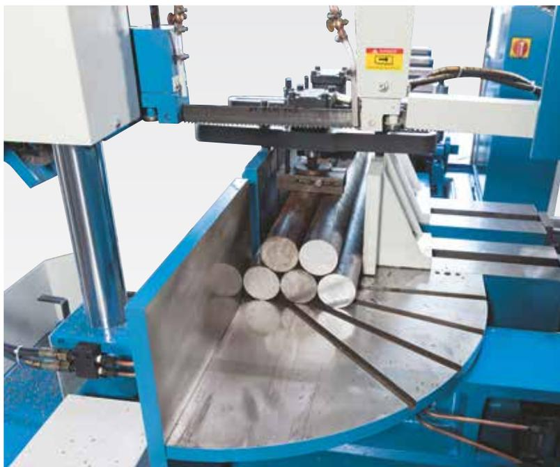
Hydraulische Bündelspanneinrichtung für beide Schraubstöcke serienmäßig
