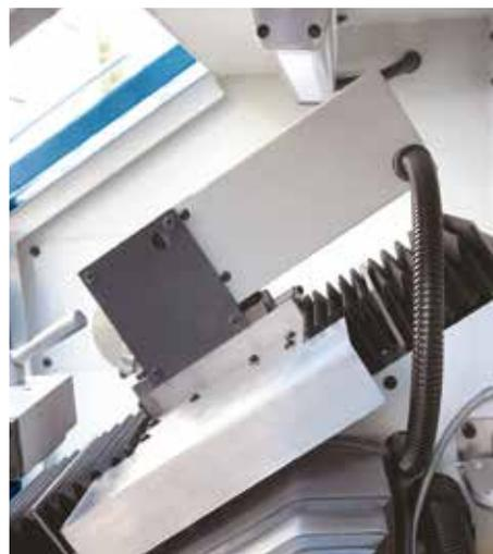
Schrägbettbauweise für optimierten Arbeitsraum und Späneabfuhr
