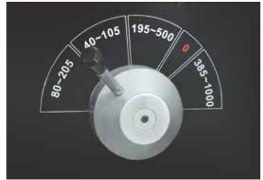
4 Getriebestufen für hohes Drehmoment im gesamten Drehzahlbereich
