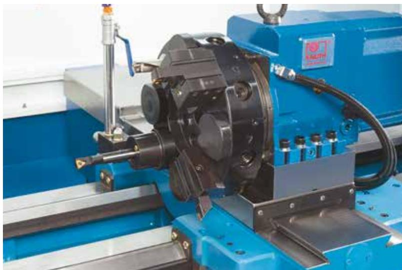
VDI 30 Werkzeugrevolver mit 8 Stationen (Numturn 420 SI)
