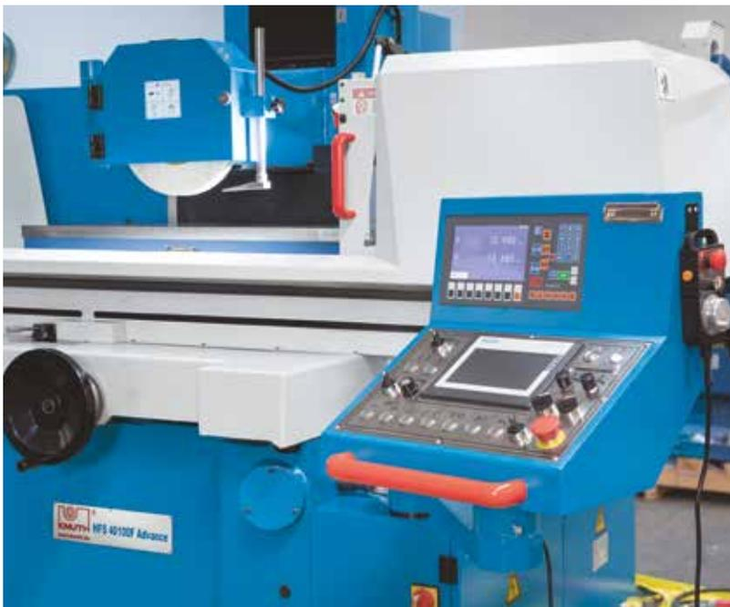
Alle notwendigen Parameter für die präzise Zustellung der Schleifspindel werden direkt am Siemens-Touchscreen erfasst und editiert
