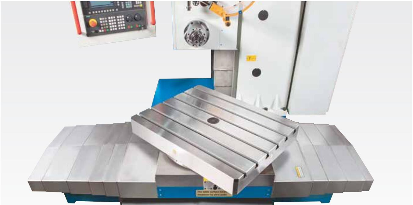
360° drehbarer Arbeitstisch mit gehärteter Oberfläche
