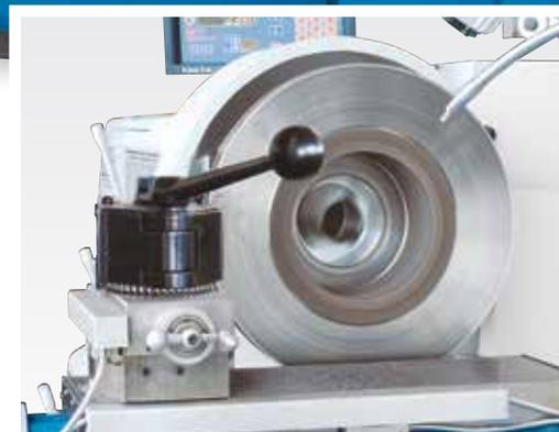
Konstante Schnittgeschwindigkeit für eine perfekte Oberfläche
