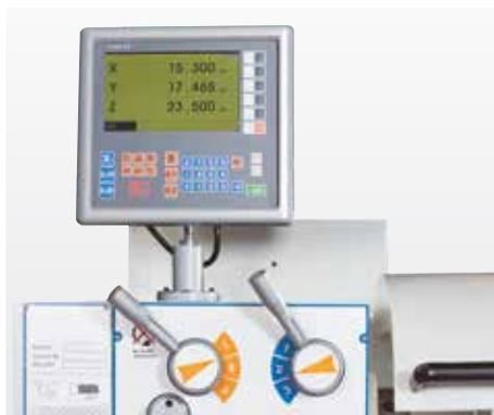
Positionsanzeige für X-, Z- und Z1-Achse
