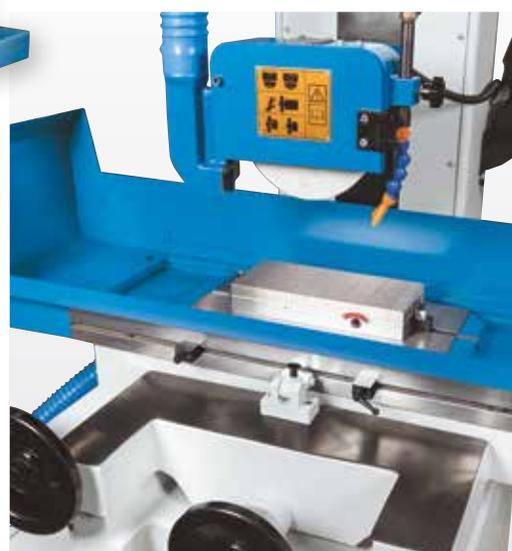
Permanent-Magnetspannplatte mit feiner Poteilung - ideal für präzise Schleifbearbeitung
