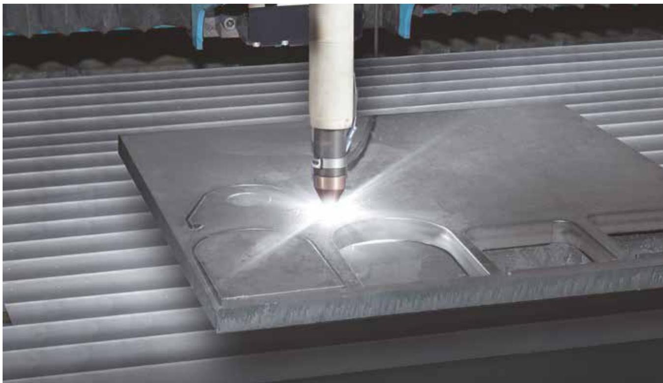
Beim Plasmaschneiden ist der elektrische Lichtbogen zwischen Elektrode und Werkstück durch eine Schneiddüse dergestalt eingeschnürt, dass mit einem Plasmastrahl hoher Energiedichte ein effektives Schneidwerkzeug für Metalle entsteht.
