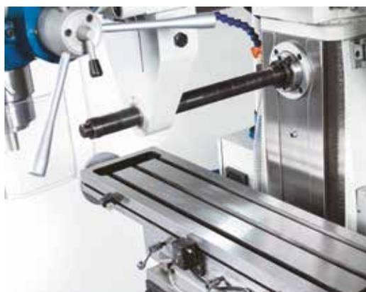
Der solide Oberbalken mit Gegenhalter ermöglicht die stabile Aufnahme langer Fräsdorne
