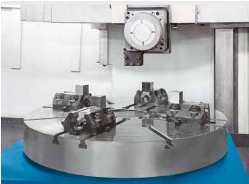
Aufspannscheibe mit 4-fach Werkzeugwechsler
