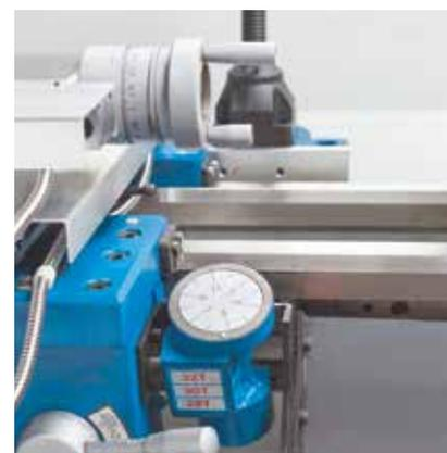
Die Gewindeuhr gewährleistet die Wiederaufnahme des Gewindegangs, nachdem die Schlossmutter für die rückläufige Bewegung geöffnet wurde
