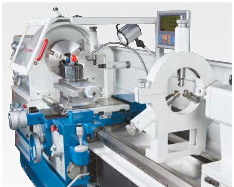
Lünetten zur präzisen Bearbeitung langer Werkstücke
