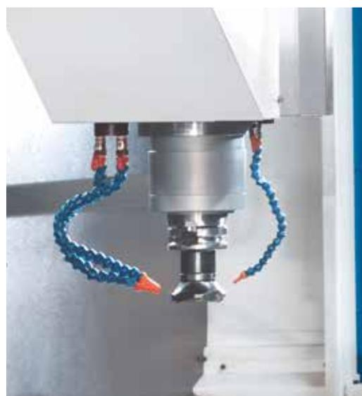
Spindelaufnahme mit Messerkopf
