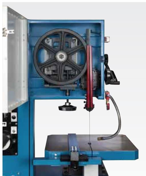
Die besonders stabile Führung des Umlenkrades garantiert dessen dauerhaft präzise Ausrichtung und steigert damit die Schneidleistung und Standzeit der Bandsägeblätter
