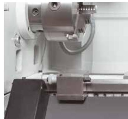
Der Mikrometer-Bettanschlag garantiert Wiederholgenauigkeit
