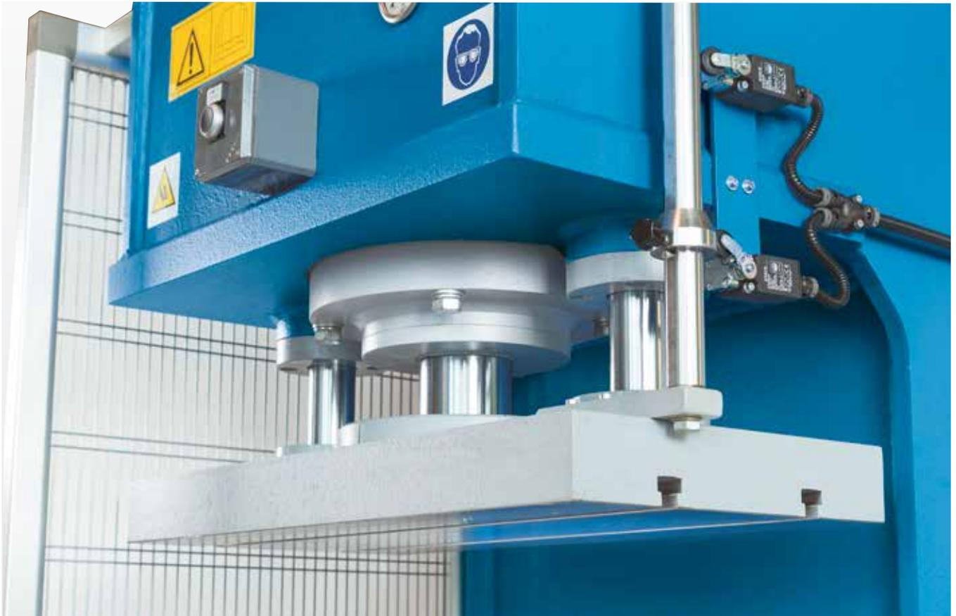
2 zusätzliche Rundführungen garantieren die Parallelität der Stößelplatte während der Bearbeitung
