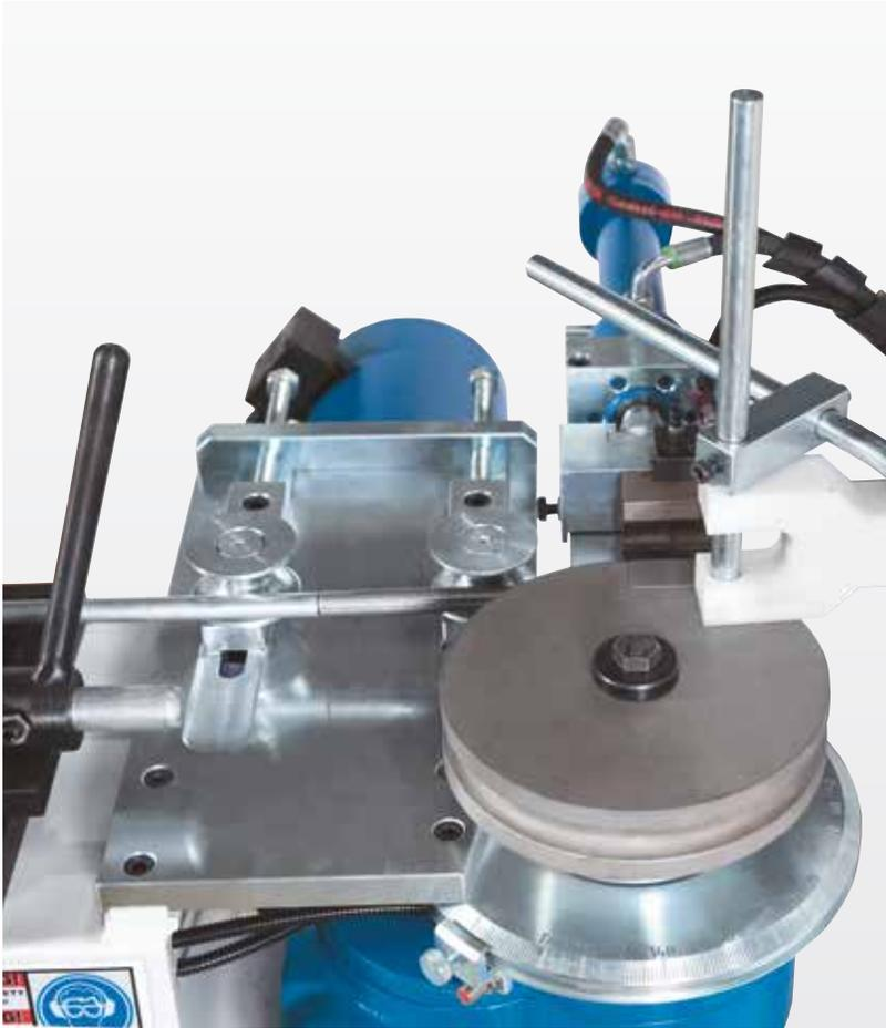
Das Werkstück wird hydraulisch geklemmt und der maximale Biege­winkel beträgt 190°
