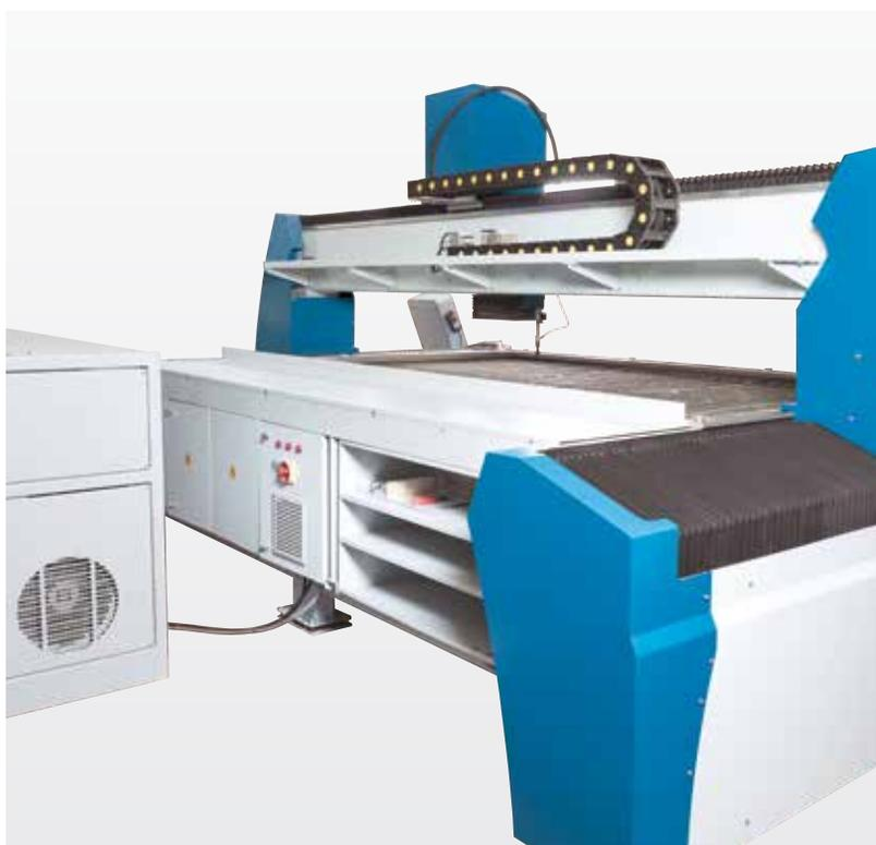
Gegen Wasser und Staub vollständig gekapselte Bewegungseinheiten
