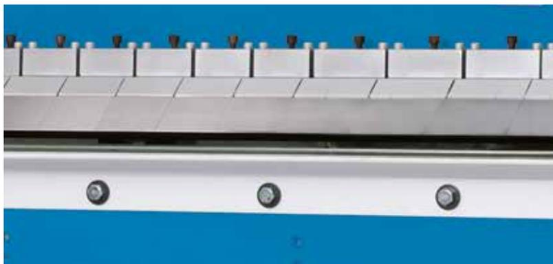
Serienmäßiges Oberwerkzeug mit Segmentteilen von 76, 102, 127 und 152 mm
