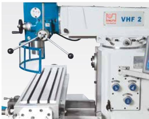
Vertikal- und Horizontalspindel mit jeweils eigenem Antrieb
