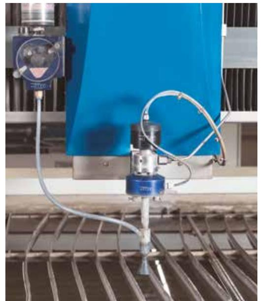
Schneidkopf und Abrasivsystem sind optimal auf das jeweilige Hochdrucksystem abgestimmt, BFT Hochdruckpumpen mit ALLFI Schneidkopf und Abrasivsystem (Abb.)
