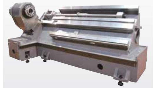
Schweres Maschinenbett mit gehärteten und geschliffenen Führungen
