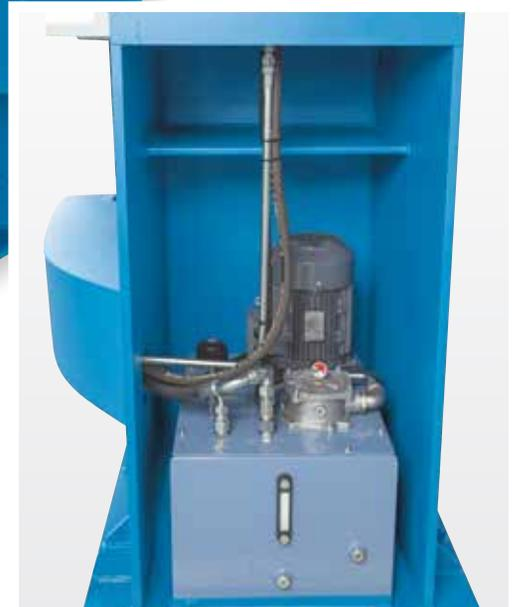
Kompakte Hydraulikeinheit integriert im Maschinenständer
