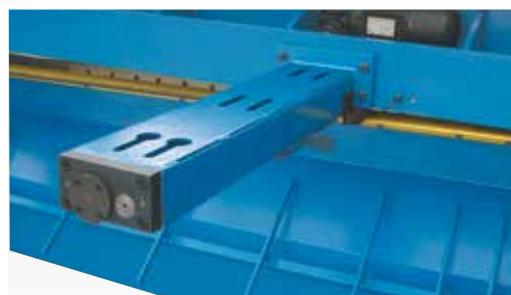
Der robuste Hinteranschlag ist dem Produktionsalltag gewachsen
