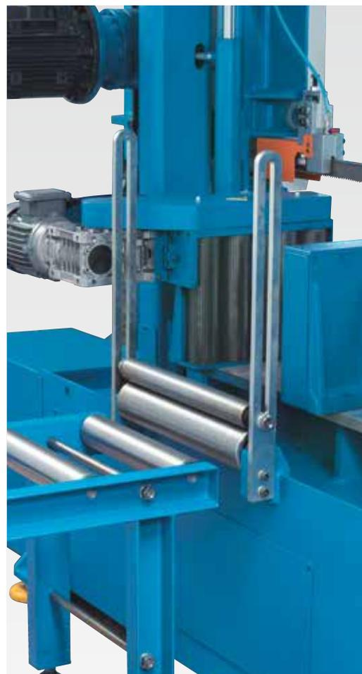
Stabile Zufuhrrollenbahn und Materialführung für Werkstückbündel
