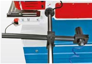
Hinteranschlag mit automatischer Schnittausslösung
