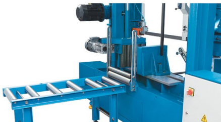
Stabilní zavážecí válečkový dopravník a vedení materiálu pro svazek obrobků
